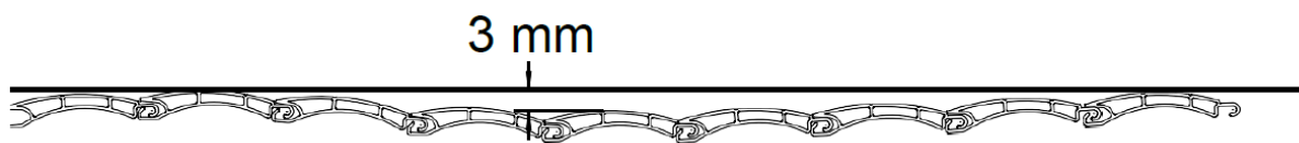
Rys. 6-4. Określanie falistości pancerza rolety 14
